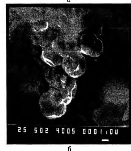
Рис. 1. Мікрофотографії зразків порошку нікелю (а) і КМ ПВХ- \text{Ni} (б) з вмістом нікелю \Theta = 0,13 об'ємної частки (збільшення 5 000 разів).
